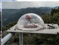
天文台の空の状況を自宅から確認するためのスカイカメラ。
