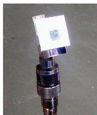
鏡ピンホールの一例。1cm角に切ったアクリルミラーを両面テープで厚紙に貼り、それをマイクスタンドに貼り付けて像を安定させる。小さな鏡がピンホールと同じ原理で太陽像を作る。
