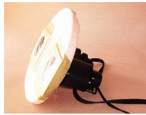
双眼鏡用フィルター枠。通称「ブタの鼻」
